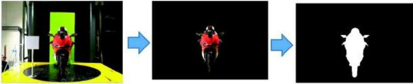
Figura 7: Fasi principali dell'elaborazione delle immagini.
