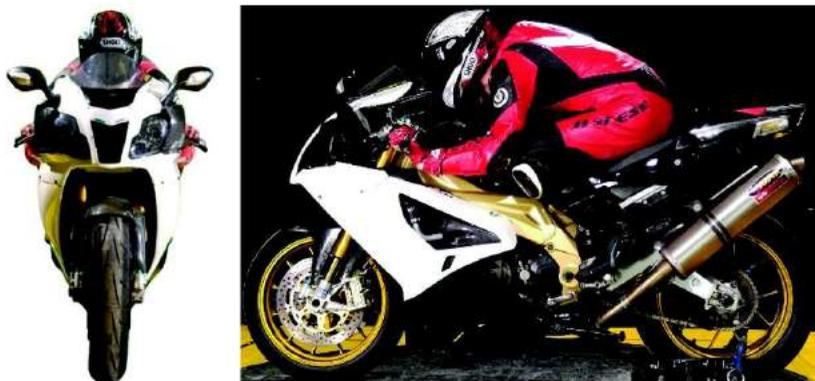
Figura 24: Aprilia RSV 1000 R Factory, a sinistra è rappresentata la sezione frontale con il pilota in carena, a destra è rappresentata la vista laterale.
