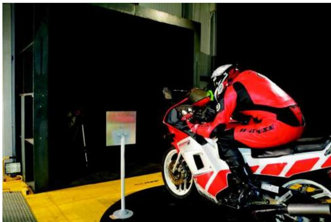
Figura 6: Acquisizione dell'immagine frontale della motocicletta: è fondamentale la presenza di un'area di riferimento per il calcolo del fattore di scala dell'immagine.
