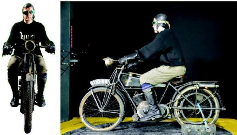
Figura 8: Terrot Model E, a sinistra è rappresentata la sezione frontale con il pilota seduto con abiti d'epoca, a destra è rappresentata la vista laterale.
