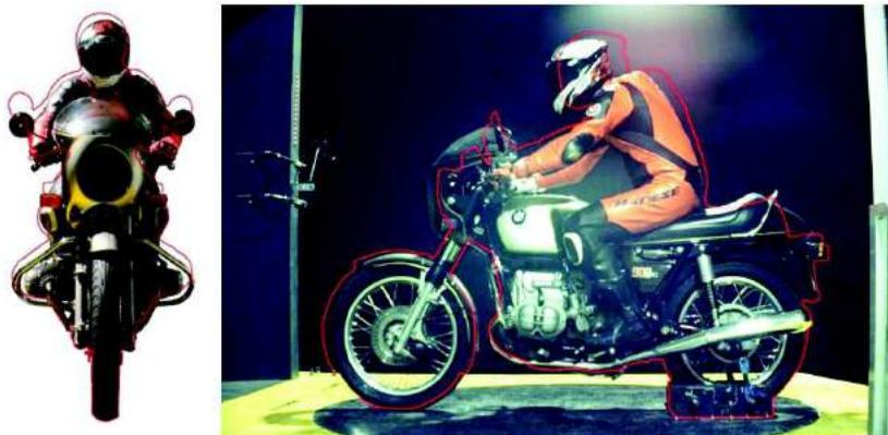
Figura 12: BMW R90 S a sinistra è rappresentata la sezione frontale, a destra è rappresentata la vista laterale. La linea rossa rappresenta il profilo della BMW R90/6 (modello analogo ma senza la presenza di cupolino).
