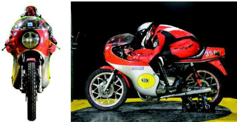
Figura 11: MV Agusta 350, a sinistra è rappresentata la sezione frontale con il pilota seduto in carena, a destra è rappresentata la vista laterale.
